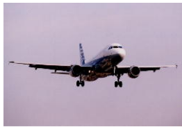
エアバスA320-200 垂直尾翼(1984年):炭素繊維強化エポキシ積層型複合材料
